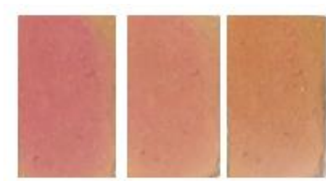
Рисунок 3.13 – Контрольные образцы без ультразвуковой обработки. Слева направо: до, 4 часа и 26 часов обработки соответственно
