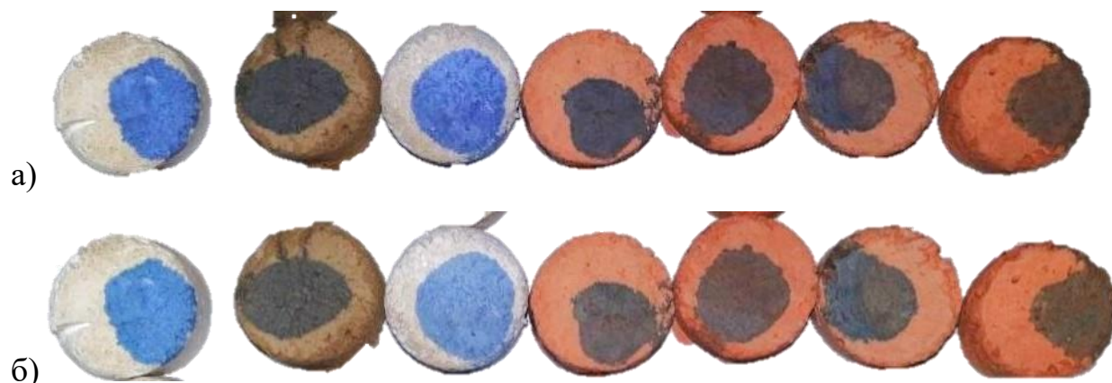
Рисунок 3.15 – Фотографии образцов №1-7 (слева направо) до (а) и после (б) облучения УФ-светом в течении 26 часов при использовании красителя метиленовый синий
