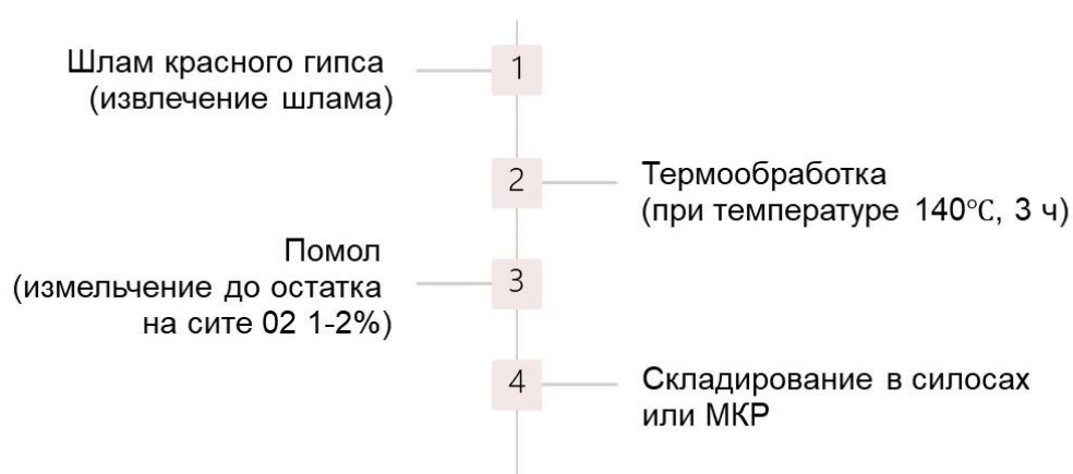
Рисунок 5.1 – Этапы технологии получения строительного красного гипса.
