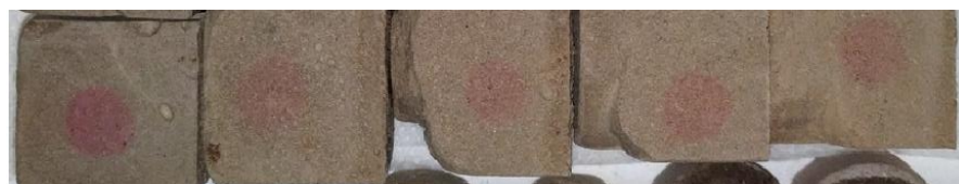
Рисунок 4.3 – Деградация красителя после облучения УФ-светом в течении 4 ч и 26 ч образцов слева направо – Г(40%), Г(45%), Г(50%), Г(55%), Г(60%)
